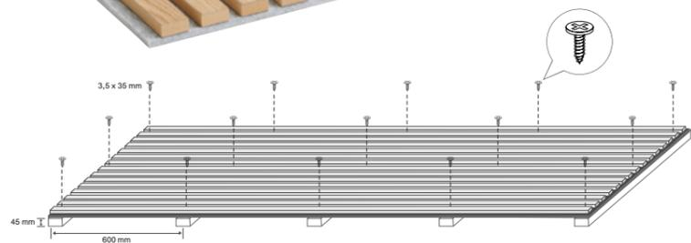
Die Paneele wird einfach durch das Akustikvlies auf die Unterkonstruktion, oder direkt auf die Wand geschraubt.
